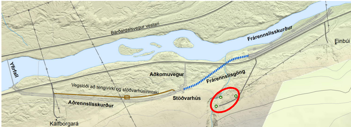
Mynd 3 Afstöðumynd Einbúavirkjunar í Bárðardal. Sýnt er hvar fyrirhugað er að staðsetja mannvirki, svo sem stöðvarhús og frárennslisgöng. Frístundabyggð við Einbúa er innan rauðusvæðisins.
